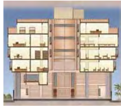
شكل (٢ - ٢٩) قطاع بالمبنى يوضح استخدام الفناء لتهوية المبنى مع الحفاظ علي الخصوصية
